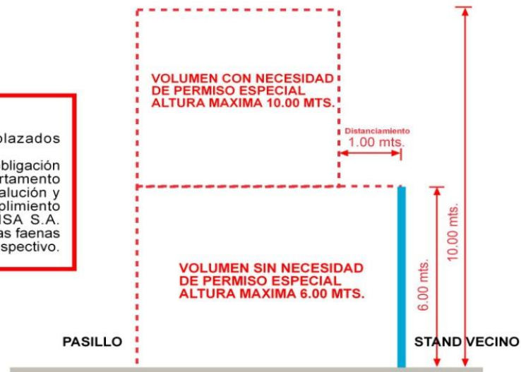
Esquema de elevación lateral
