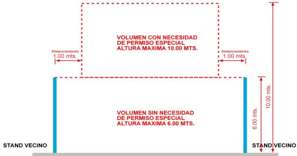
Esquema de elevación frontal
